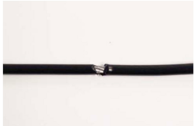
Spalt im Kabelmantel
