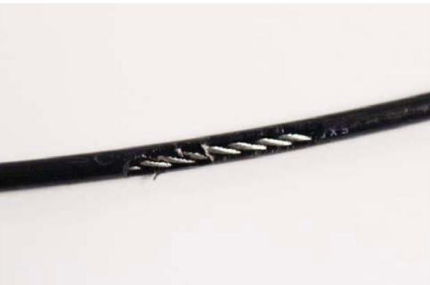
Riss im Kabelmantel
